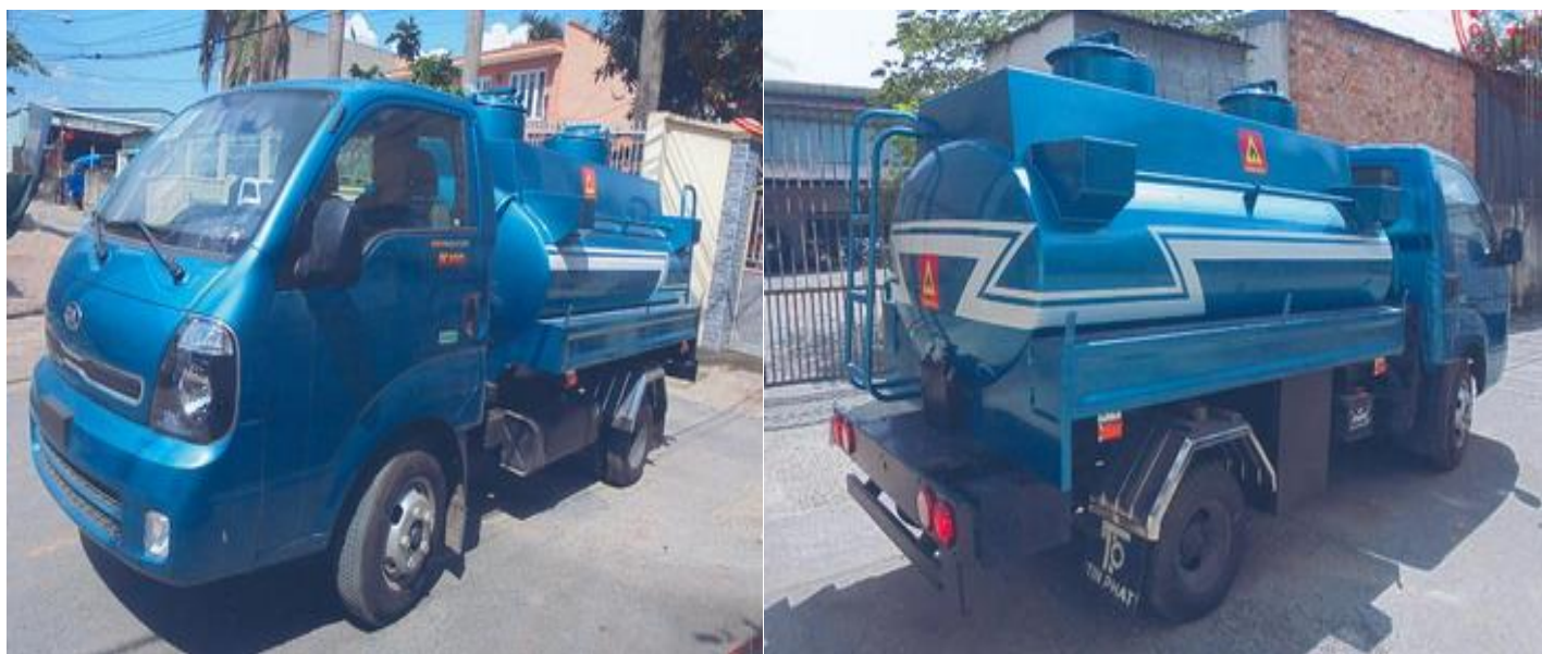
Hình 2: Hình chụp tổng thể xe bồn chở xăng dầu 3 khối KIA K250 tiêu chuẩn.
