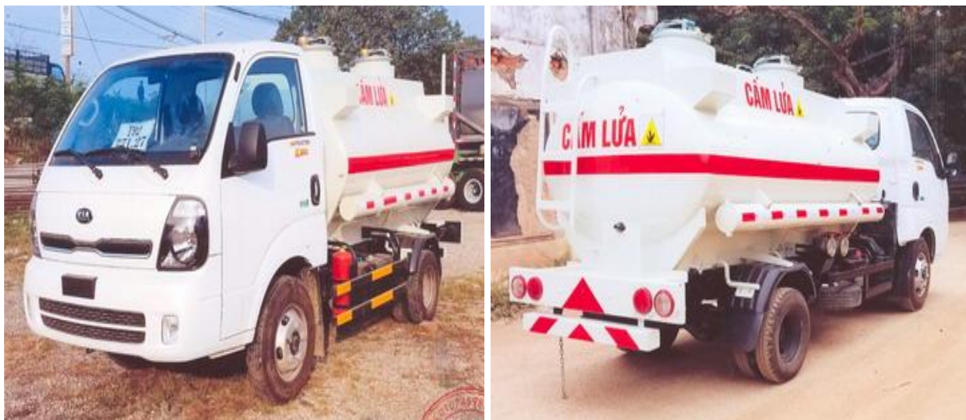
Hình 1: Hình chụp tổng thể xe bồn chở xăng dầu 3 khối KIA K250 có bơm cấp lẽ lưu động
