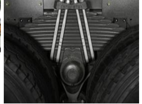
Hệ thống treo phụ thuộc, nhíp lá (11 lá), giảm chấn thủy lực
