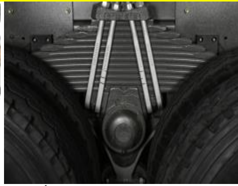
Hệ thống treo phụ thuộc, nhíp lá (11 lá), giảm chấn thủy lực
