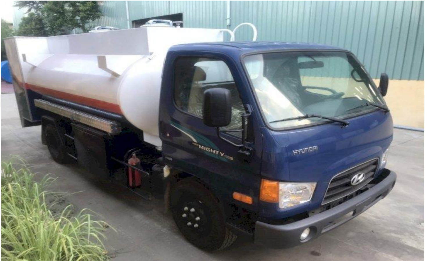
Hình 1: Xe bồn nhôm 7 khối trang bị bơm cấp lễ lưu động TATSUNO của Nhật Bản.
